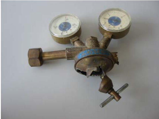
Bilder 3 und 4 ausgebrannte Druckminderer
